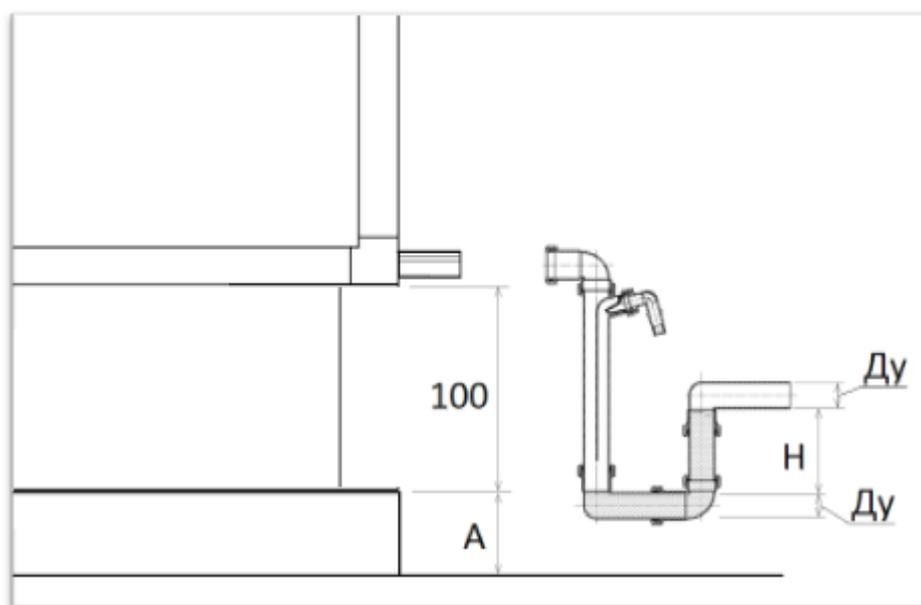
Рис. 16. Расчет высоты сифона с избыточным давлением.
