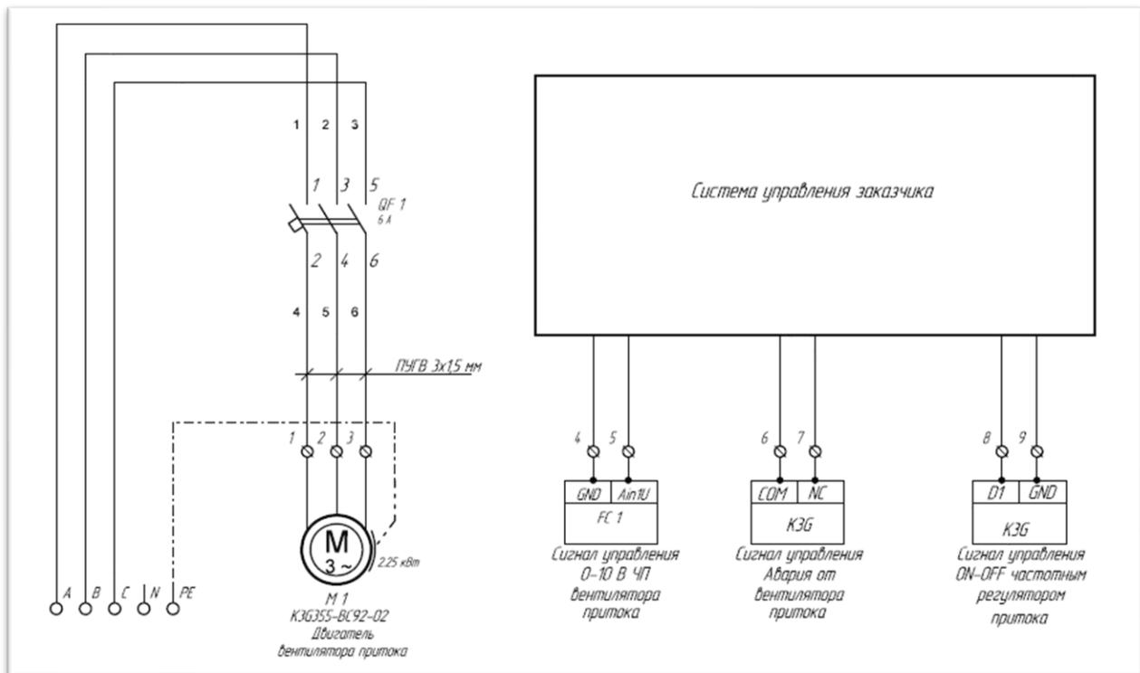
Рис. 11. Схема подключения ЕС двигателя
