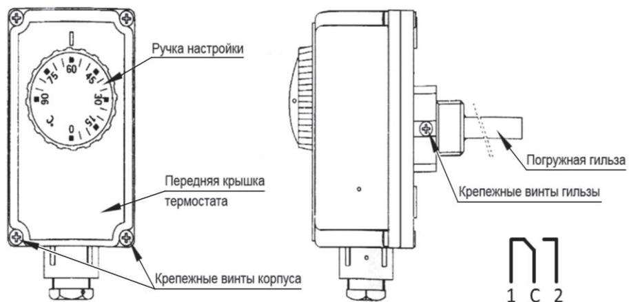
Рис. 20. Погружной термостат ДРТП. Схема подключения клеммы.
