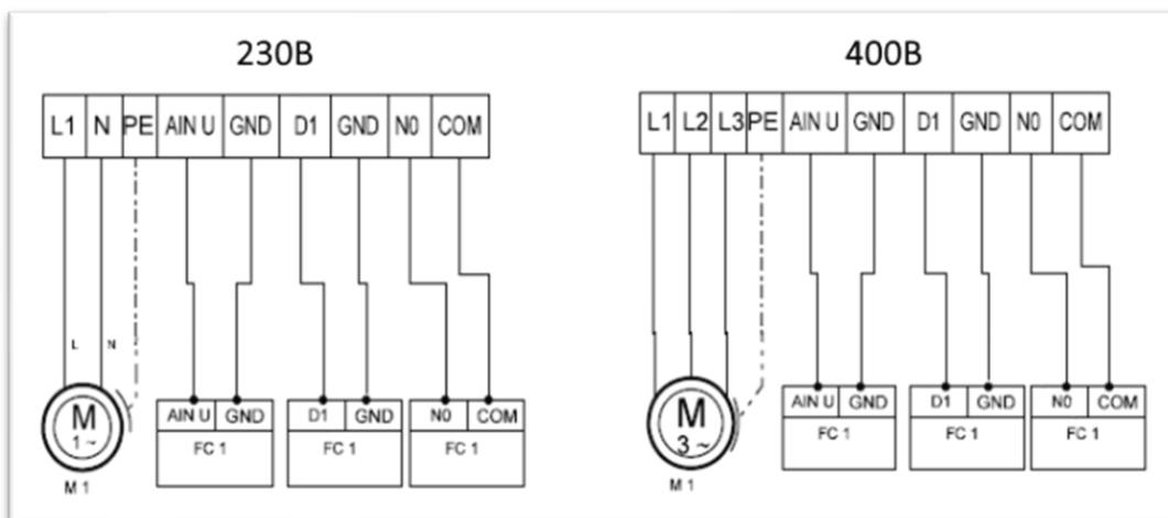
Рис. 9. Подключение ЕС двигателя
