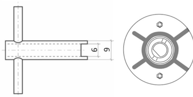
Рис. 21. Ключ для настройки термостата ДРТП
