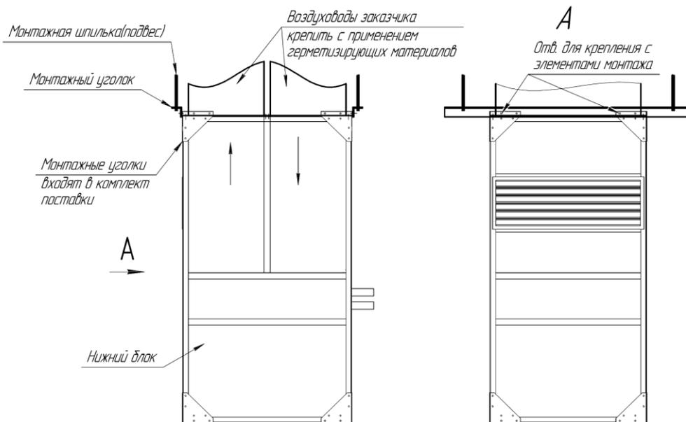
Тилы монтажных уголков и монтажных шпилек(подвеса) предусмотреть в соответствии с общей массой нижнего блока
