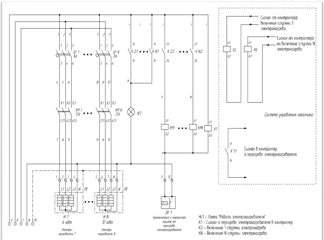
Рис. 19. Схема электрического подключения электронагревателя
