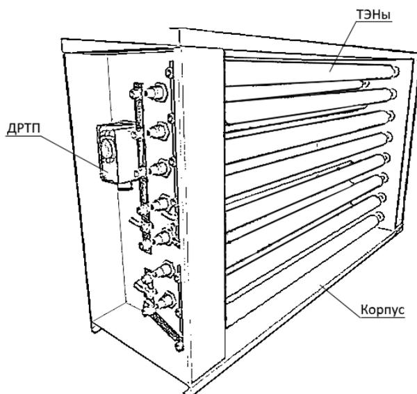
Рис. 18. Электрический нагреватель
