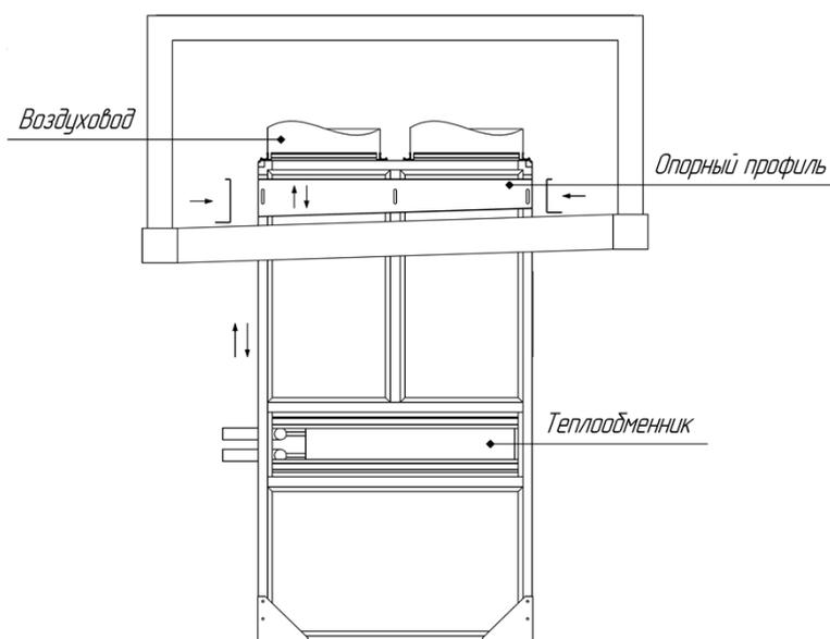
Рис. 6. Монтаж секции ВКВ на крыше с уклоном
