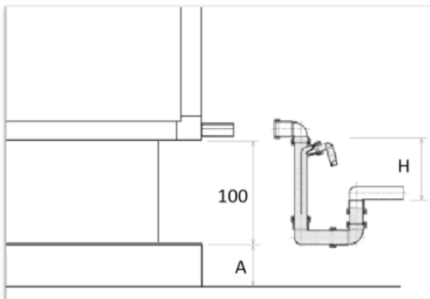
Рис. 17. Расчет высоты сифона с разрежением.
