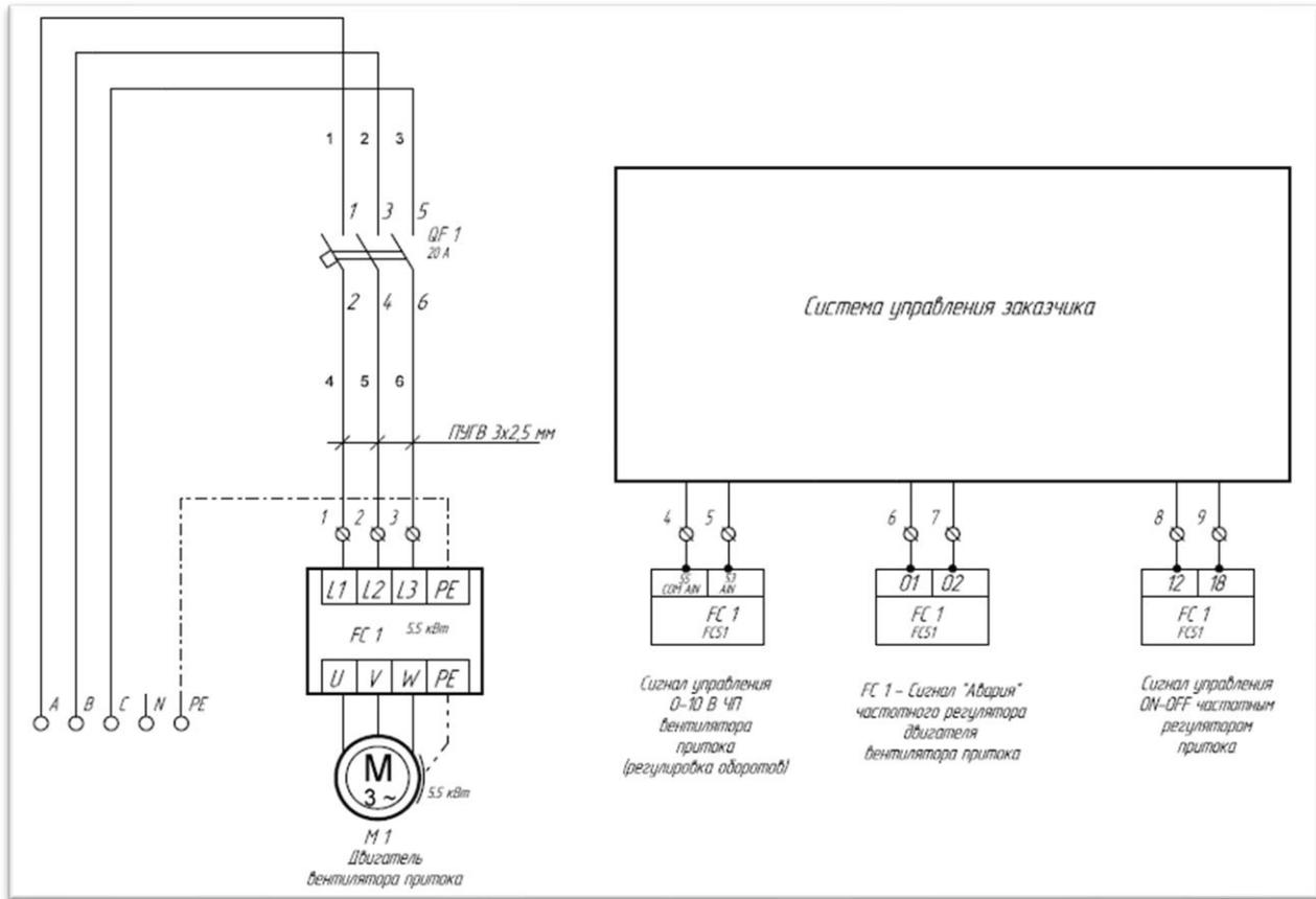
Рис. 10. Схема подключения АС двигателя
