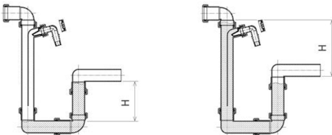
Рис. 15. Сифон с избыточным давлением и разрежением
