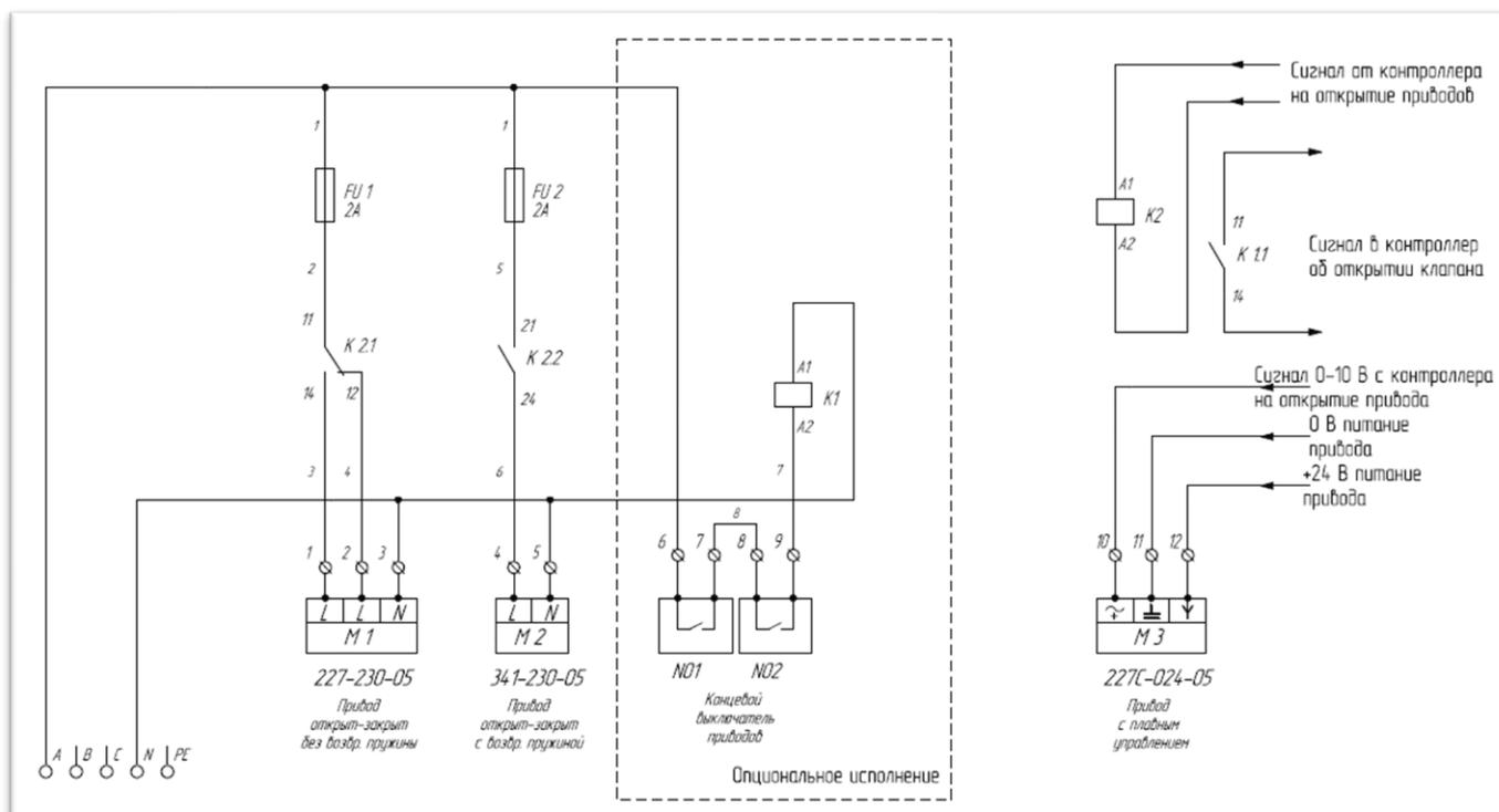
Рис. 25. Электрические подключения воздушных клапанов
