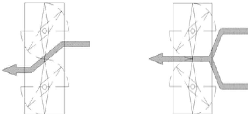
Рис. 24. Типы воздушных клапанов с параллельными и встречными створками
