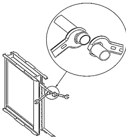
Рис. 12. Подключение жидкостного теплообменника
